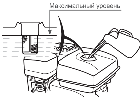
Рис. 14 Максимальный уровень топлива в топливном баке
