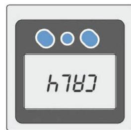
Поверните прибор на 90° по часовой стрелке на том же самом месте и нажмите кнопку **НОЛЬ**. Пиктограмма «**CAL3**» сменится на «**CAL4**».
