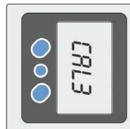
Поверните прибор на 90° по часовой стрелке на том же самом месте и нажмите кнопку **НОЛЬ**. Пиктограмма «**CAL2**» сменится на «**CAL3**».
