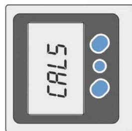
Поверните прибор на 90° по часовой стрелке на том же самом месте и нажмите кнопку **НОЛЬ**. Пиктограмма «**CAL4**» сменится на «**CAL5**».
